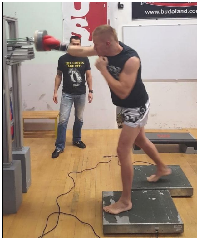
Abbildung 11: Schlagauführung der geraden Schlaghand auf zwei FITRONIC s.r.o. Kraftmessplatten
