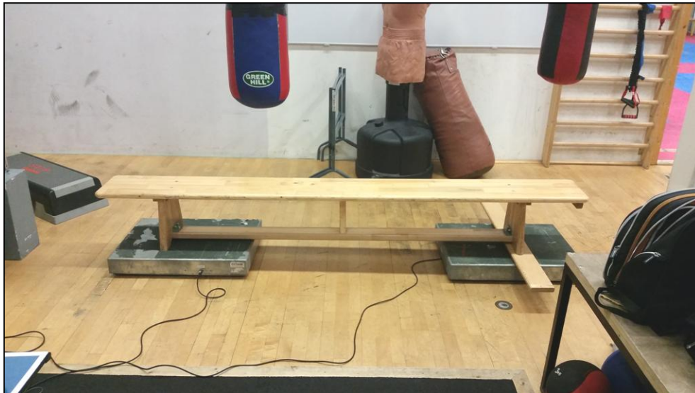
Abbildung 12: Versuch die Ausstoßbewegung mit dem Medizinball über die Kraftmessplatten zu berechnen
